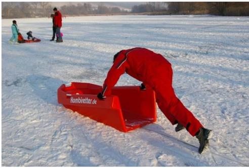
Der KR ist neben dem Wassereinsatz ebenso ein idealer Eisretter, der in kritischen zugefrorenen Eisbereichen eingesetzt werden kann. Dadurch ist ein schnelles Vorankommen durch Schieben möglich. Die Sicherungsleine wird dabei von der Schlepp-Öse unter dem KR zwischen den beiden Kufen nach hinten zum Leinenführer gelegt. Dabei muss der Retter allerdings aufpassen, dass er dabei nicht auf die Leine tritt.
